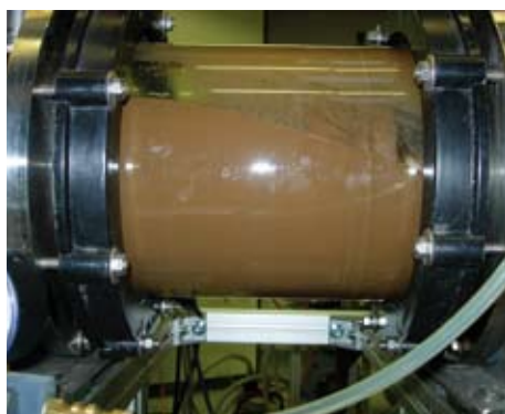
Bild 2: Labormodul des Rotationsscheibenfilters mit aufkonzentriertem Überschussschlamm nach Filtrationsende, der bei 4,5 % Trockenrückstand nicht mehr fließfähig ist.
