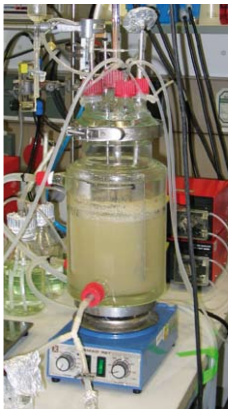
Bild 3: Bioreaktor zur fermentativen Produktion von Chitinasen. Figure 3: Bioreactors for fermentative production of chitinases.
