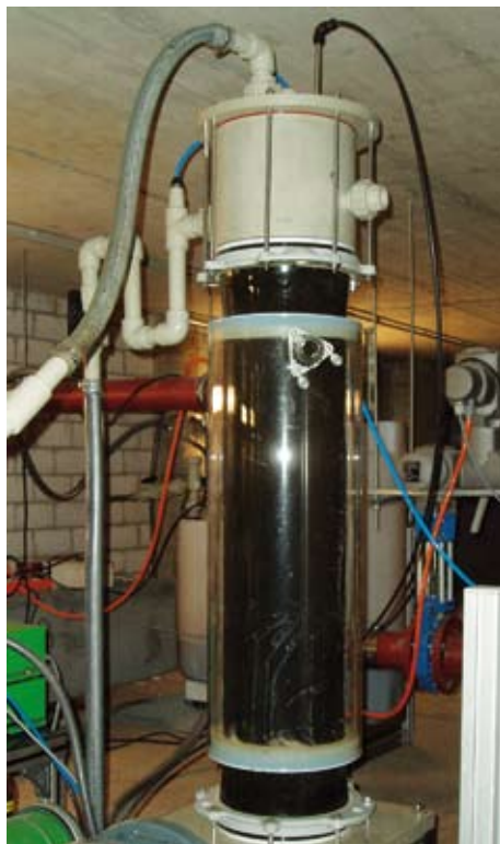
Bild 1: Anaerob betriebener Membran-Bioreaktor zur Reinigung von Krankenhausabwasser am Robert-Bosch-Krankenhaus, Stuttgart.
