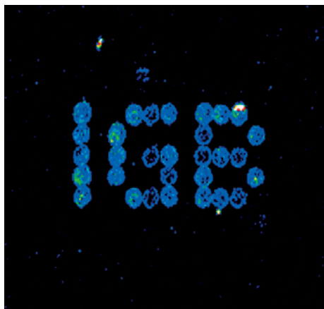
Bild 1: Fluoreszierende Nanopartikel im Mikrometermaßstab auf einem Chip angeordnet, gesehen mit einem Fluoreszenz-Scanner.
