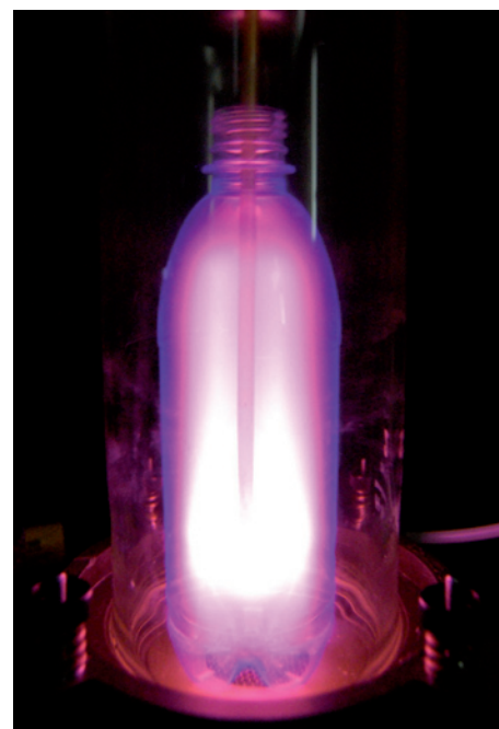
Bild 1: Beschichtung der Flascheninnenseite mittels Niederdruck-Plasma (pink leuchtend). Figure 1: Plasma process (pink luminescent) for coating the inside of bottles.
