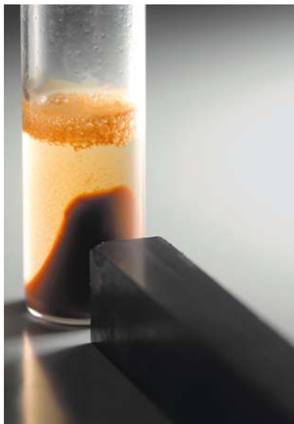
Bild 4: Nanopartikel mit Polymerschale und magnetisierbarem Kern (Magnetit), welche durch einen Magneten (rechts) angezogen werden.
