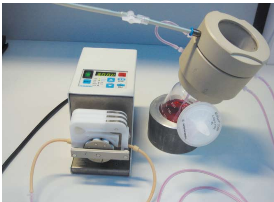
Bild 1: Biorektoraufbau mit peristaltischer Pumpe, Medienvorratsflasche und darauf aufgesetztem Bioreaktor.
