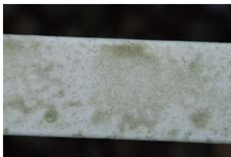
Bild 2: Beispiel einer Armlehne nach 9-monatiger Exposition: Deutlich erkennbar haben sich Pilze und Algen angesiedelt und bilden unschöne Flecken. Figure 2: Example of an armrest after 9-months exposure: fungi and algae have colonized the armrest and become clearly visible by forming unattractive stains.
