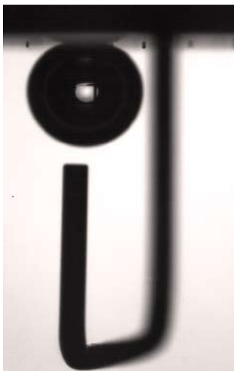
Bild 2: Bestimmung des Benetzungswinkels \varphi in einem Tränensimulanz. Figure 2: Measuring of wetting angle \varphi in simulated tears.
