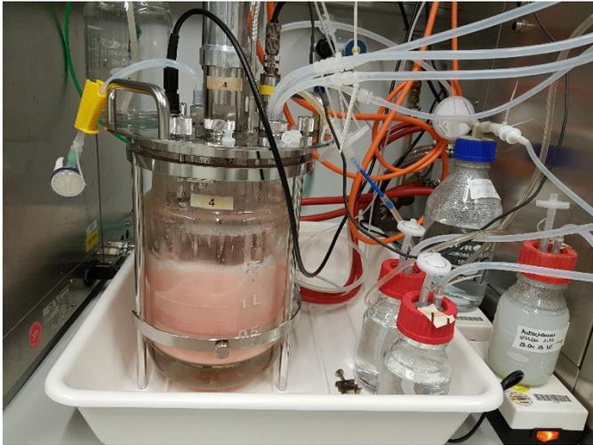
**Abb. 3** Aufbau eines Bioreaktors zur Anzuchtung großer Mengen Biomasse von *M. extorquens* AM1.
