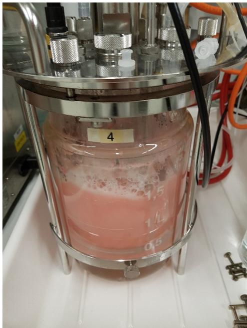
**Abb. 4** Detailaufnahme eines Bioreaktors zur Anzuchtung großer Mengen Biomasse von *M. extorquens* AM1.
