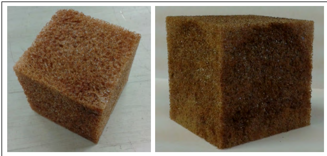
Abb. 220: Polyurethanschäume auf Basis von Organosolv-Lignin (Quelle: Uni-HH/TI)
