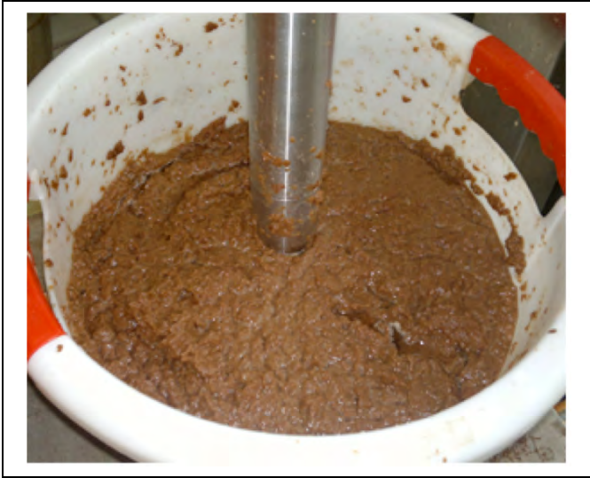
Abb. 47: Organosolv-Fasern nach der Zerkleinerung (Quelle: BTS)
