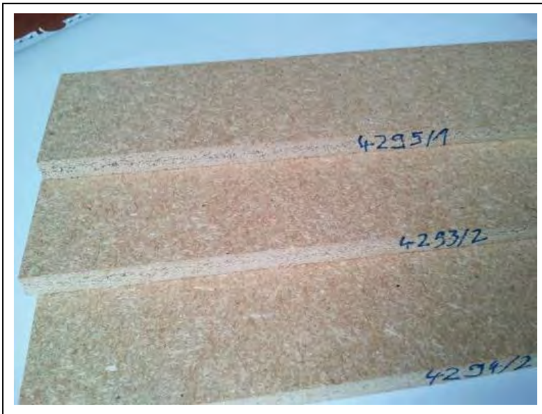
Abb. 153: Spanplatten der Laborversuchs-Bindemittel mit 10 % bzw. 20 % Phenolsubstitution sowie unmodifizierte Referenz (Quelle: Dynea)
