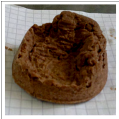
Abb. 52: Cellulose-Faserkuchen nach Filtration (Quelle: BTS)
