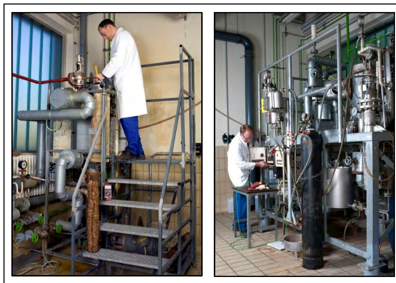
Abb. 1: Aufschluss im Uni-HH/TI Technikum im 1-kg- (links, Viertopfkoher) und im 6-kg-Maßstab (rechts, 30-L-Kocher) (Quelle: Uni-HH/TI)
