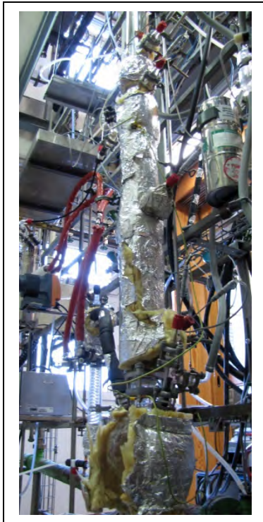
Abb. 65: Mehrstufen-Miniplant-Apparatur (BTS) für kontinuierliche thermische Ligninfällung (Quelle: BTS).
