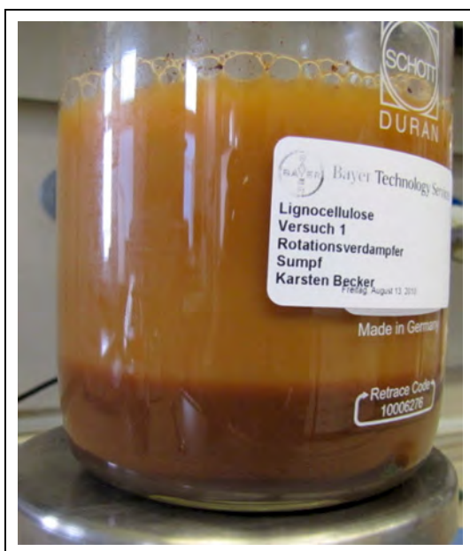
Abb. 62: Sumpffraktion nach therm. Fällung , Mutterlauge ICT, ohne Schwefelsäure (Quelle: BTS)
