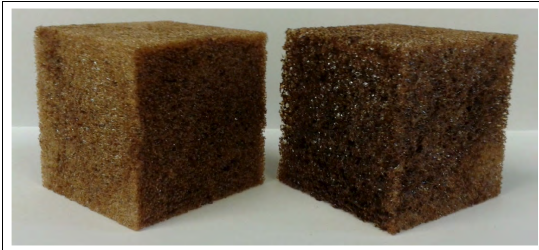
Abb. 224: Polyurethanschäume aus Organosolv-Lignin (links) und hydroxypropyliertem Organosolv-Lignin (Quelle: Uni-HH/TL)
