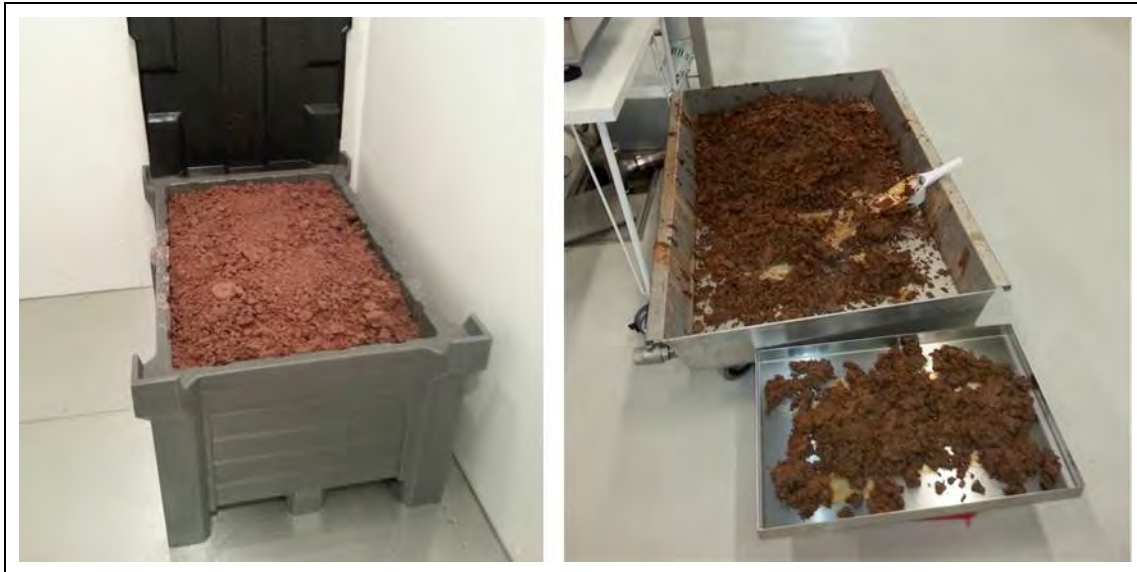
Abb. 79: Gewonnene Fraktionen des ersten Holzaufschlusses der LCB-Pilotanlage. Links: entwässerte Cellulosefraktion. Rechts: Lignin nach der Filtration (Quelle: CBP)
