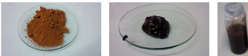
Abbildung 105: Unmodifiziertes Lignin (rechts) in Polyol eindispersiert bzw. gelöst (Mitte, rechts)
