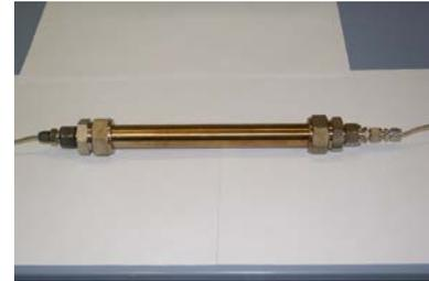
Abbildung 33: Prinzipieller katalysierter Prozess zum hydro-cracking von Lignin und BCD-Oligomeren in Tetralin sowie Darstellung eines ausgewählten Reaktors für screening-Untersuchungen.
