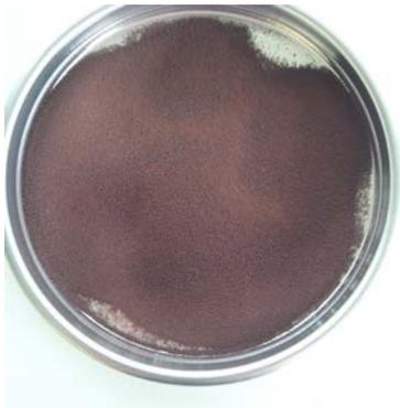
Abbildung 100: Kraftlignin I (Feststoffgehalt: 96%, Schüttdichte tr.: 0,41 kg/m<sup>3</sup>)
