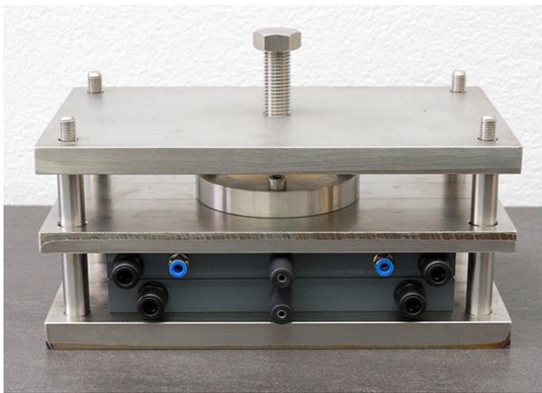
**Nur aus Luft und Wasser stellen Fraunhofer-Forscher in dieser elektrolytischen Zelle mit Strom Wasserstoffperoxid für den dezentralen Einsatz her.**
