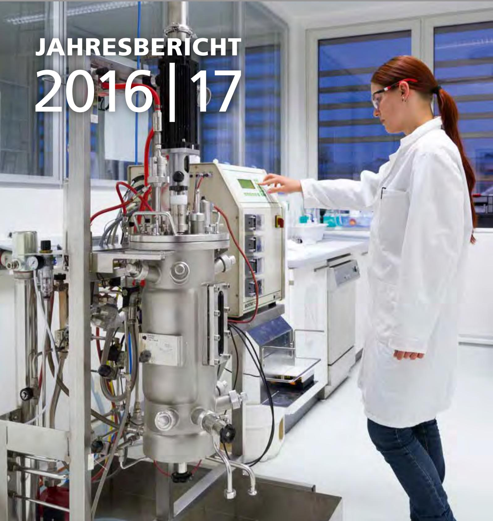
Bioreaktor zur Umsetzung von nachwachsenden Rohstoffen mit Mikroorganismen. Im Straubinger Institutsteil BioCat werden biotechnologische Verfahren bei Bedarf auch mit chemischen und elektrochemischen Prozessen kombiniert, um aus Biomasse neue Produkte für die chemische Industrie herzustellen.
