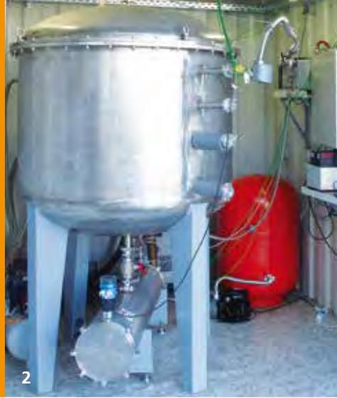
Wärmeenergie bedarfsgerecht für die Gebäudeheizung zur Verfügung zu stellen und somit den Primärenergieverbrauch zu senken. Durch die entwickelten Komposit-Adsorbentien konnte die Ladetemperatur von  $> 120\text{ °C}$  auf  $80\text{ °C}$  gesenkt werden. Zudem ermöglicht die optimierte Auslegung des Gesamtprozesses eine deutliche Steigerung der spezifischen Leistung von  $120\text{ W/kg}$  auf  $269\text{ W/kg}$ .
