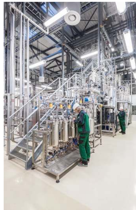
Bioreaktorkaskade zur Skalierung von Fermentationsprozessen am Fraunhofer CBP
