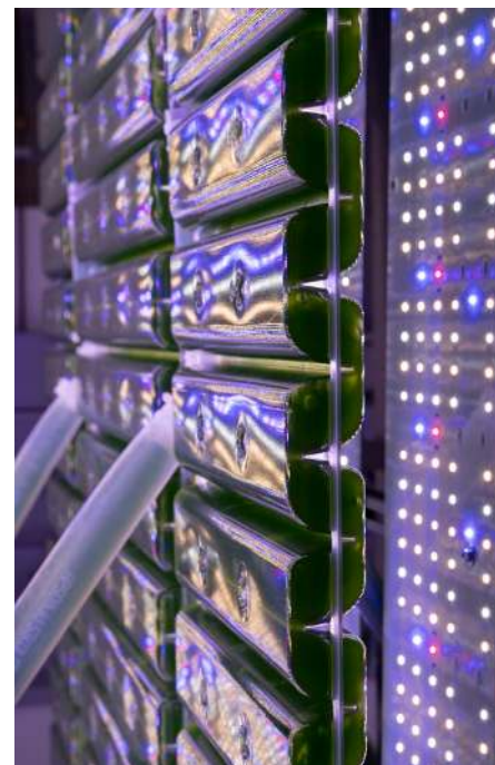
Photobioreaktor zur Kultivierung von Mikroalgen
