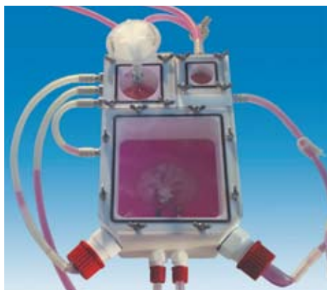
Bild 2: Im computergesteuerten Bioreaktor wird das vaskularisierte Lebermodell unter physiologischen Bedingungen kultiviert.
