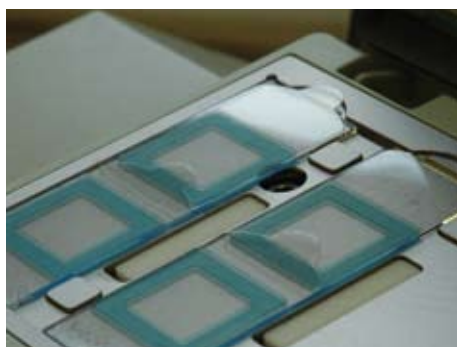
Bild 2: Hybridisierung und enzymatischer Nachweis der DNA von klinischen Isolaten auf vier unabhängigen DNA-Microarrays auf zwei Glas-Objektträgern. Zur Versuchsdurchführung wird ein Thermomixer (Eppendorf) verwendet. Figure 2: Hybridization and enzymatic detection of DNA from clinical isolates on four separate microarrays located on two chips. A thermomixer (Eppendorf) was used for the test procedure.
