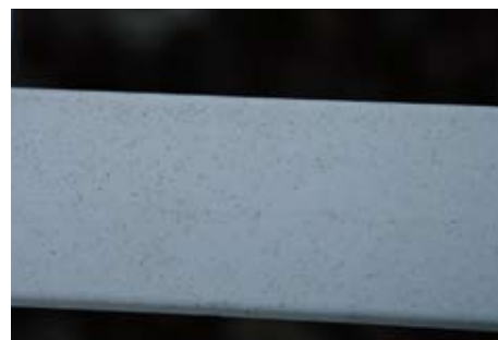
Bild 3: Mit Photokatalysator versehene Kunststoffarmlehne nach derselben Expositionsdauer: nur sehr kleine Flecken sichtbar. Figure 3: Plastic armrest treated with a photocatalyst after the same exposure time: the visible stains are very small.
