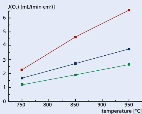
wall thickness 120 μm — 180 μm — 250 μm
