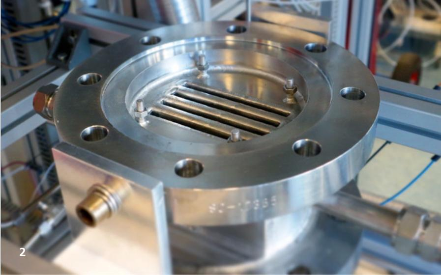
2 Reaktor zur Herstellung langkettiger Alkohole nach dem Fischer-Tropsch-Verfahren.
