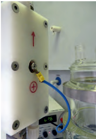
Laborzelle zur anodischen Oxidation und kathodischen Reduktion.
