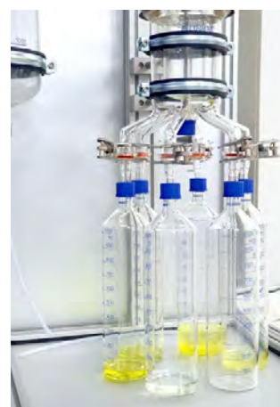
oben: Mehrstufiger Vakuumverdampfer.
