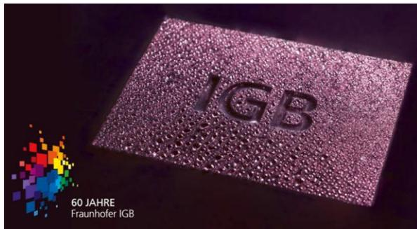
**Mittels Plasmatechnik wurde die Oberfläche des Schriftzugs IGB hydrophil ausgerüstet. Wasser bildet hier einen gleichmäßig benetzenden Film, während es an den nicht behandelten Stellen abperlt.**
