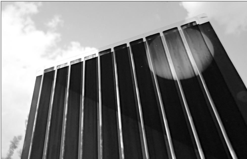
**Gedruckte Organische Solarzellen auf ultradünnem Glas. (© Fraunhofer IAP) | Bild in Farbe und Druckqualität: [www.fraunhofer.de/presse](http://www.fraunhofer.de/presse)**
