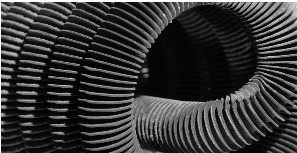
Bei thermischen Prozessen ist Oberfläche gefragt, um ausreichend Platz für die Anreicherung von Wasser bzw. Wasserdampf zu haben – wie hier bei einem MOF-beschichteten Wärmetauscher.
