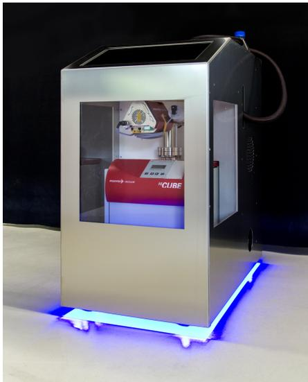
**Mit diesem kompakten Massenspektrometer können bis zu 30 Komponenten gleichzeitig in der Gasphase und einer Flüssigkeit analysiert werden.**
