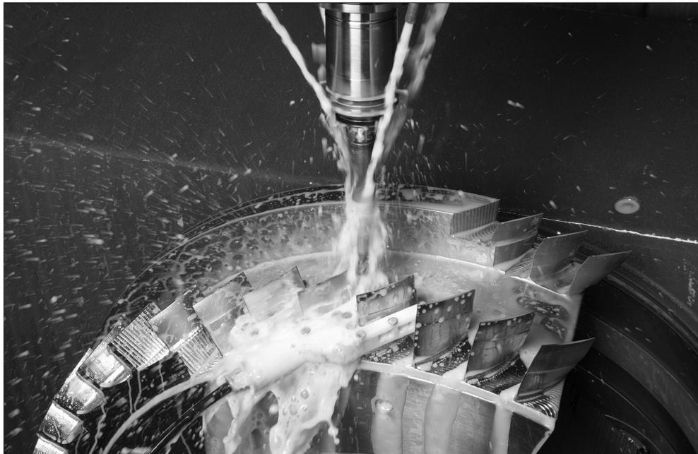
Das dreiteilige Spannsystem fixiert die Schaufeln der Blisk (untere Bildmitte in weißer Farbe). Von oben wird Kühlschmierstoff eingespritzt. (© Fraunhofer IPT) | Bild in Farbe und Druckqualität: [www.fraunhofer.de/presse](http://www.fraunhofer.de/presse)
