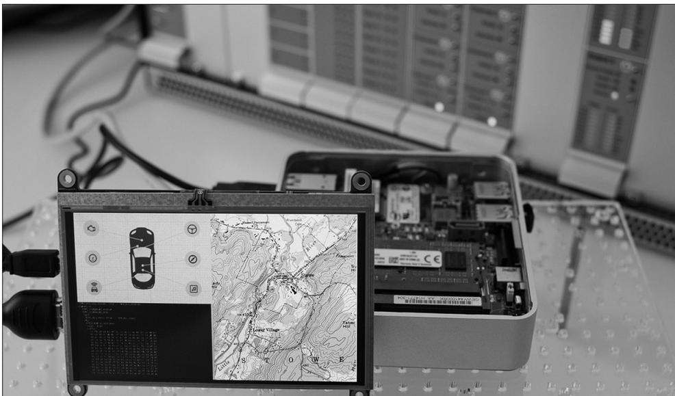
**Der Demonstrator für eine »Head Unit« schützt sowohl Daten des Herstellers als auch private Daten des Fahrzeugnutzers vor unberechtigtem Auslesen. (© Fraunhofer SIT) | Bild in Farbe und Druckqualität: [www.fraunhofer.de/presse](http://www.fraunhofer.de/presse)**
