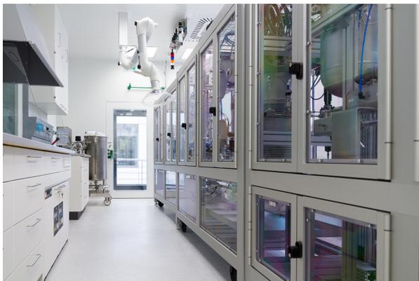
**In der Druckwechseltechnologie-Forschungsanlage am Fraunhofer IGB kann die Haltbarmachung von Getränken und flüssigen Lebensmitteln, aber auch der Aufschluss von Zellen, untersucht werden.**
