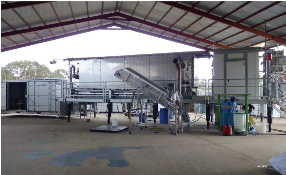
Die Pilotanlage besteht aus einem Container mit Vorlagebunker und Energiezentrale sowie einem Rahmen, in dem die Reaktoren zur Trocknung und Torrefizierung, die Vorrichtung für den Feststoffaustrag und die Kondensatoren untergebracht sind. © Fraunhofer IGB | Bild in Farbe und Druckqualität: [www.fraunhofer.de/presse](http://www.fraunhofer.de/presse).
