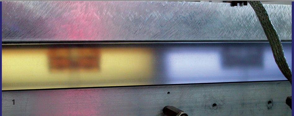
1 *Plasmabehandlung zur Sterilisation von zwei Sterisafe® Sterilbehältern aus unterschiedlichen Materialien (links: Polyetherimid, rechts: Polyphenylsulfon) in einem Plasma-Reaktor.*
