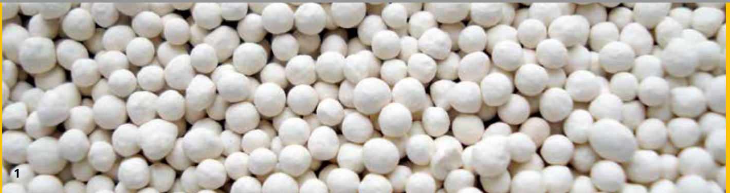
1 Zeolithschüttung im Versuchsreaktor.
