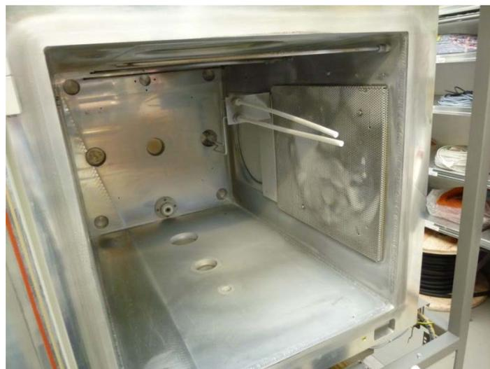
Abbildung 77: Kammer mit Kunststoff-Gaslanzen nach den ersten Beschichtungsprozessen.
