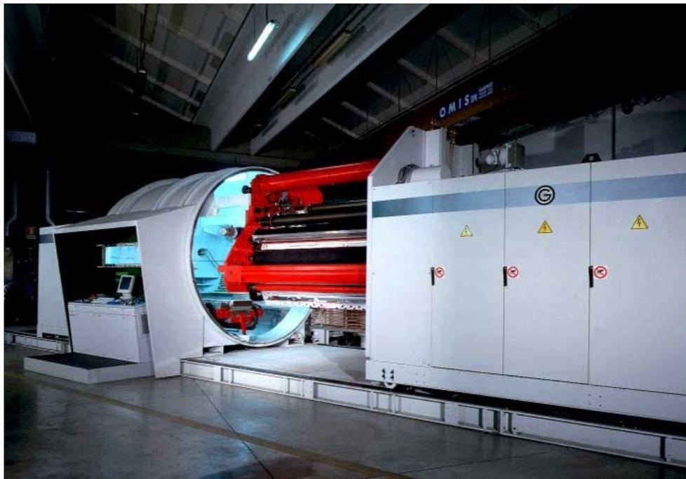
**Abbildung 4: Rollcoater der ROWO Coating GmbH.**
