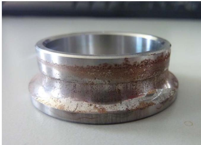
**Abbildung 34: Innenring Schrägkugellager 7006 nach Milchschröpfung.**
