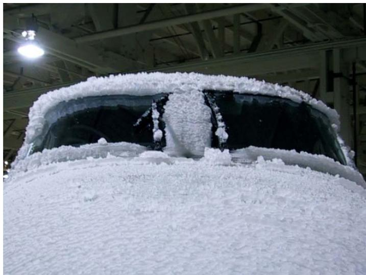
**Abbildung 42: Eisbildung auf der Flugzeugvorderseite einer King Air [12].**
