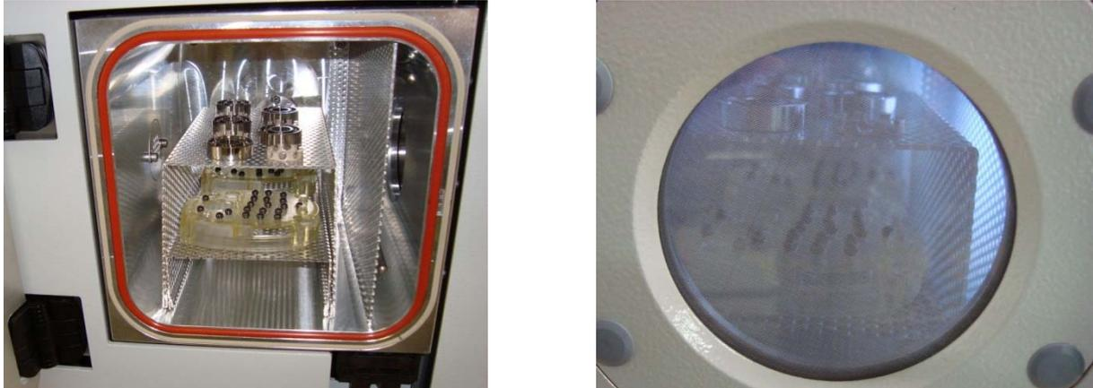
**Abbildung 10: Kugellagerbeschichtung in einer Plasmaanlage vom Typ V6-G, links vor dem und rechts während des Prozesses.**
