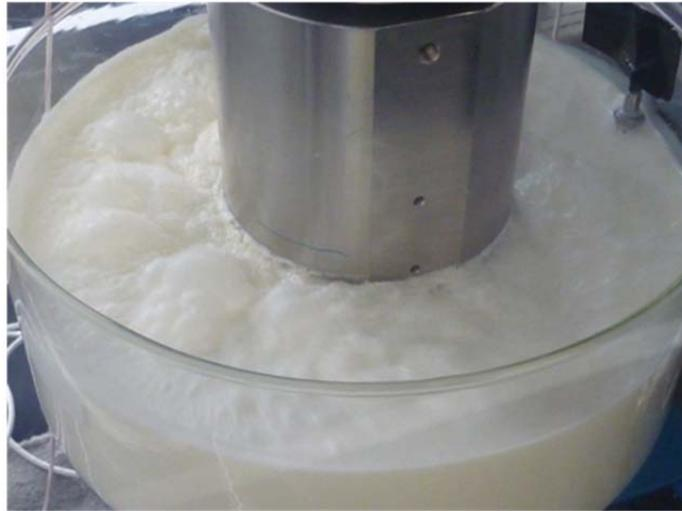
Abbildung 30: Prüfaufbau mit Prüflager (Prüflager 7006).
