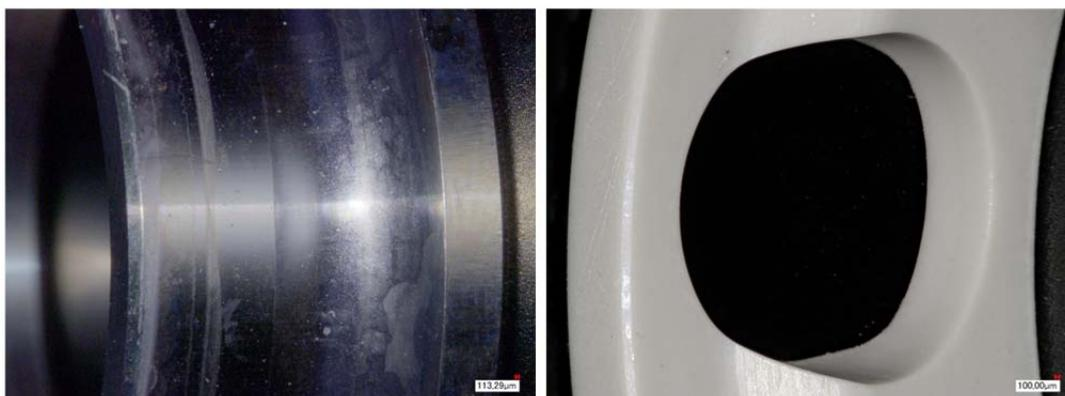
**Abbildung 36: Innenring, Käfig nach Reinigungsprozess,  $\text{CHF}_3$ -Plasmaschicht.**
