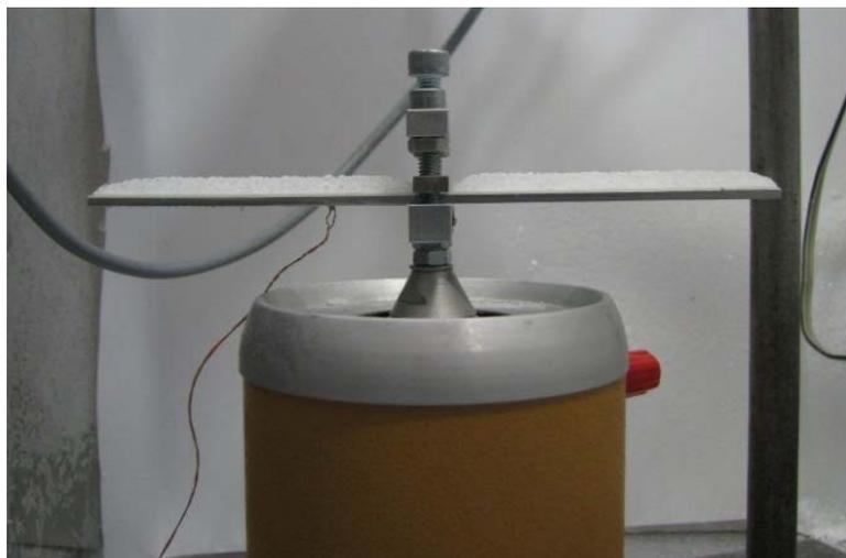
**Abbildung 59: Shaker mit symmetrischer Biegebalkeneinspannung.**
