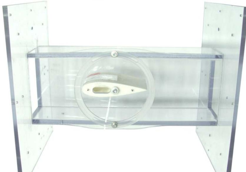
Abbildung 66: Vereisungstestsektion mit NACA 0024 Profil.
