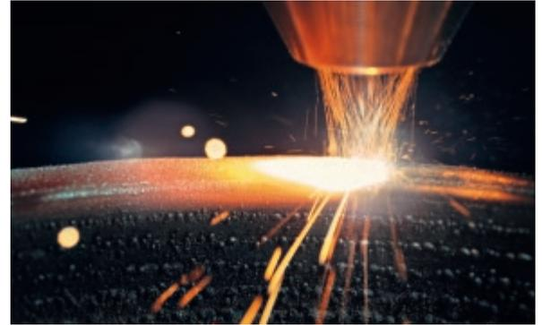
Bild 8. Beim Laser-Auftragschweißen wird Metallpulver vom Laser aufgeschmolzen. Die Metalltropfen verbinden sich mit dem darunter liegenden Bauteil. (Quelle: DMG MORI)
