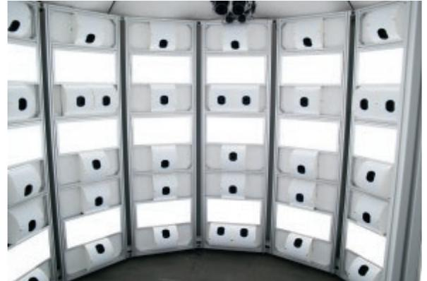
Bild 19: 3-D-Kameras der Firma botspot für 3-D-Modelle von Menschen. (Quelle: VDI e.V.)
