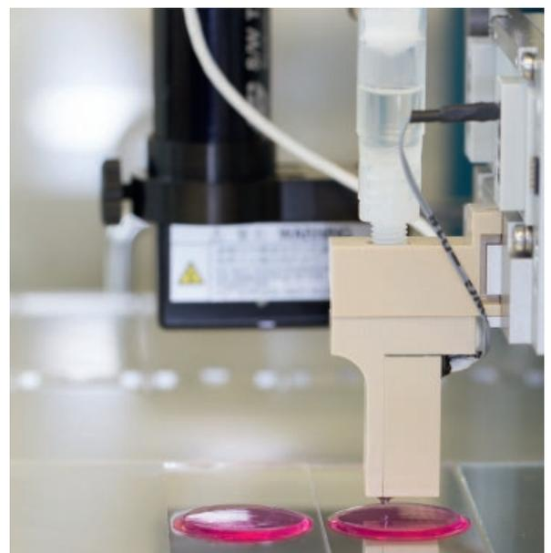
Bild 38. Inkjet-Druck von fotovernetzbarer Gelatine-Lösung (gelbliche Lösung in der Kartusche) auf Hydrogel-Substrate (rosa). (Quelle: Fraunhofer IGB)
