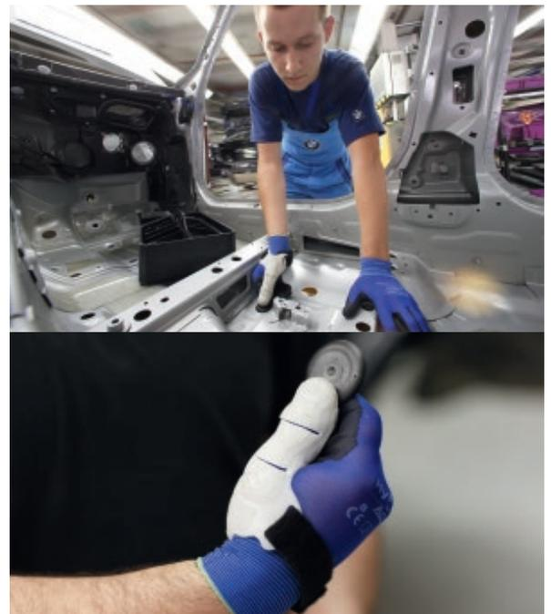
Bild 16. Einsatz der additiven Fertigung in der Automobilindustrie zur optimalen Unterstützung der Mitarbeiter in der Fahrzeugmontage (oben) und Detailaufnahme der Daumenunterstützung (unten) (Quelle: BMW Group Presseclub [11])
