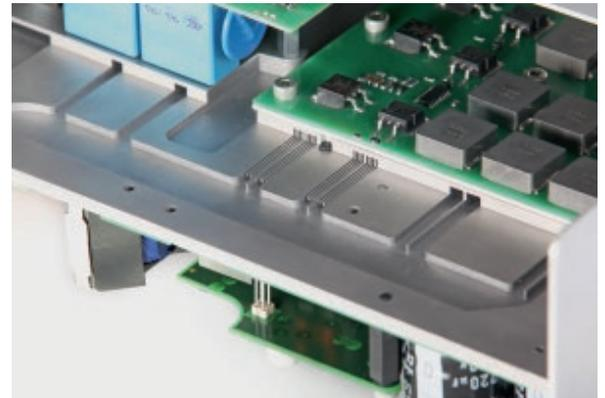
Bild 13. Demonstrator eines On-Board-Ladegeräts für Elektrofahrzeuge mit einem hybrid gefertigten Leistungselektronikgehäuse und additiv gefertigter Kühlstruktur (Quelle: EDAG)
