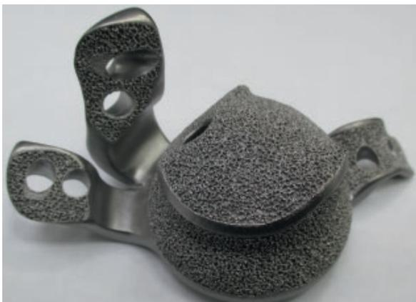
Bild 17. Für einen Patienten individuell additiv gefertigter Beckenteilersatz aus einer biokompatiblen Titanlegierung mit offenerporiger Struktur an der Knochen-Implantat-Schnittstelle (Quelle: implantcast)
