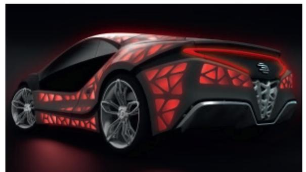
Bild 28. Konzeptfahrzeug mit bionischer Tragstruktur (Quelle: EDAG)
