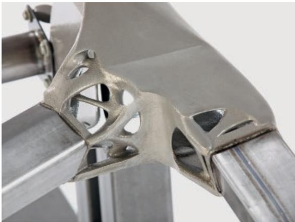
Bild 29. Der Space-Frame in Bild 28 wurde durch Kombination der additiven Fertigungsverfahren mit konventionellen realisiert (Quelle: EDAG)
