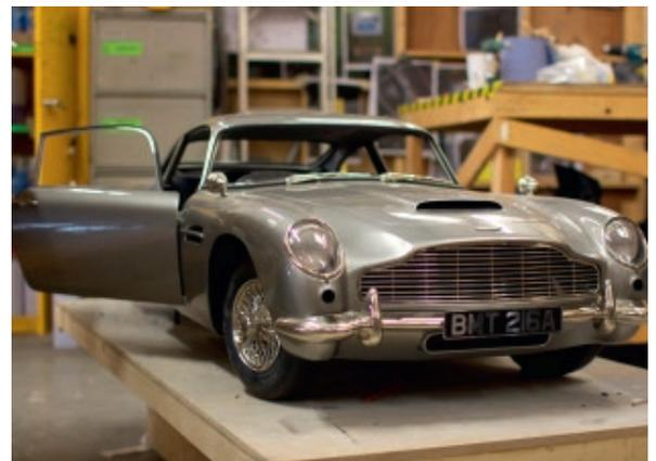
Bild 22. Additiv gefertigtes Karosseriemodell eines Aston Martin (oben) und fertig aufbereitetes Modell (unten) für eine Filmproduktion. (Quelle: Propshop Modelmakers)
